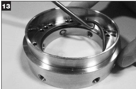
13 Vyjměte a zlikvidujte O-kroužek (Y) zámkového kroužku.
