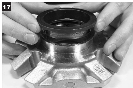
17 Z příruby vyjměte a zlikvidujte vnitřní stacionární těsnící kroužek.
