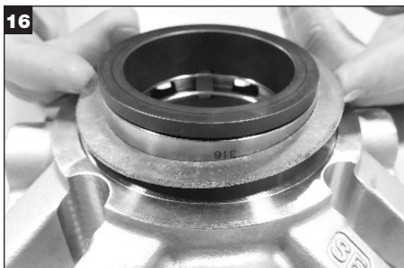
16 Z adaptéru vyjměte a zlikvidujte těsnění.
